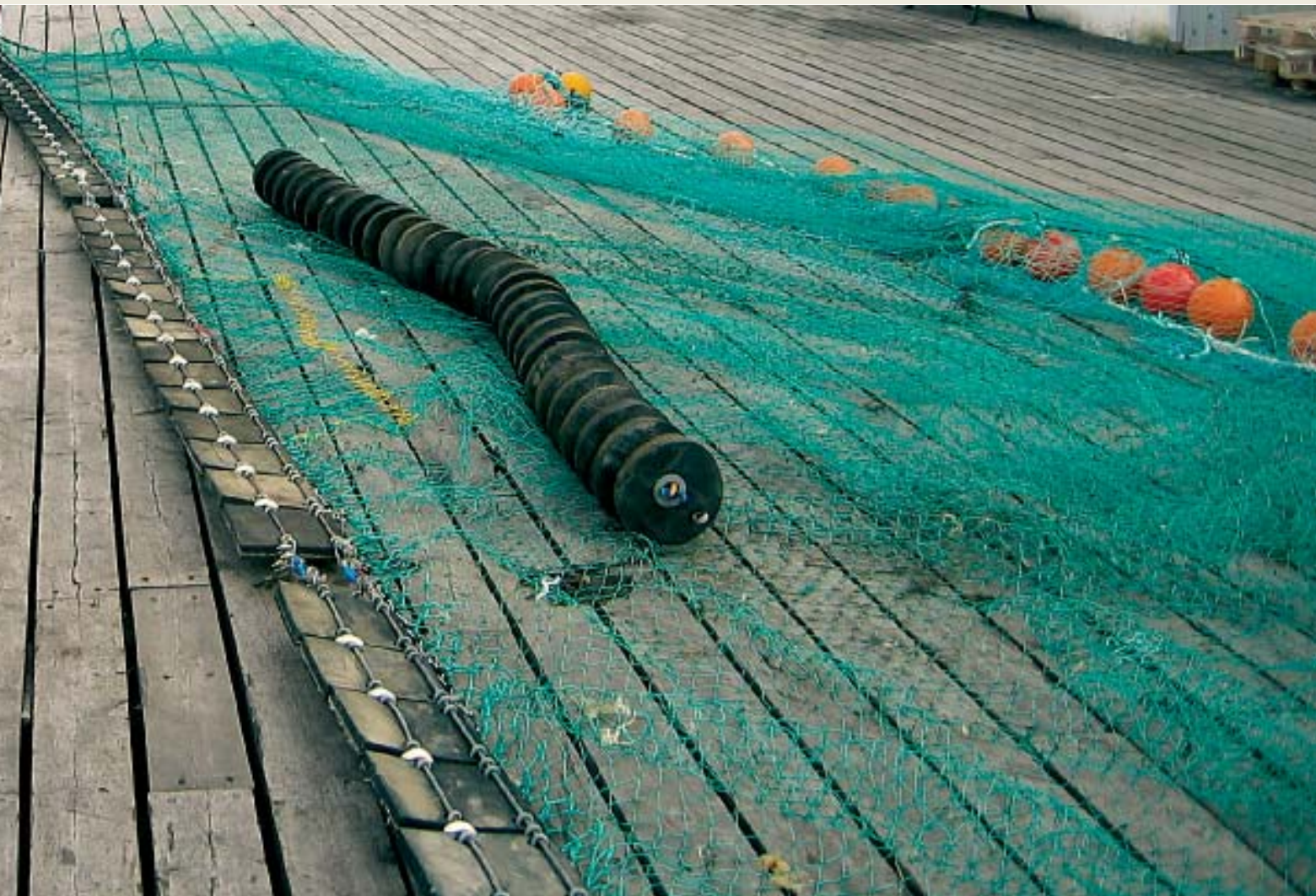
Trål montert med selvspredende plater.
